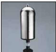
ERITECH® INTERCEPTOR INTMKIV-SS (702089) 2 kg Молниеприемник для небольших зон защиты или объектов высотой <20 м.
